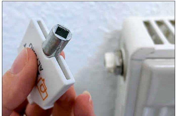
Mit einem Entlüfterschlüssel lässt sich die Luft im Heizkörper ganz einfach ablassen
