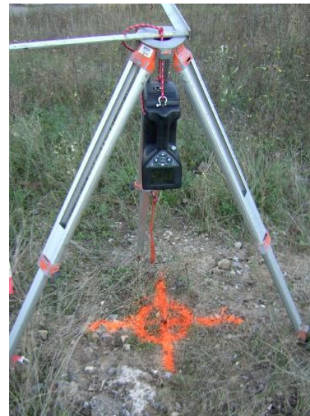
Abbildung 4-1: Gammaskpektrometer mit Stativ zur Einstellung einer definierten Messhöhe von 1 m.
